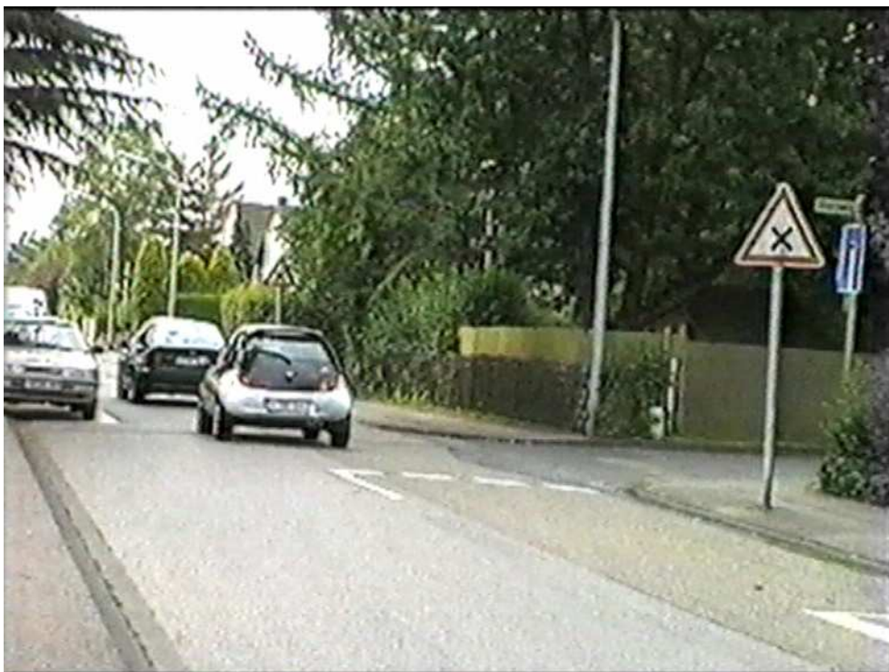
Značka A3 „Křižovatka“ v Německu upozorňuje na přednost vozidel přijíždějících zprava. V České republice je značka A3 stále platná dle vyhl.30/2001 Sb., ale téměř vůbec se nepoužívá
